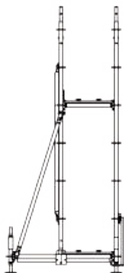
F – působení síly podle osy lešení
